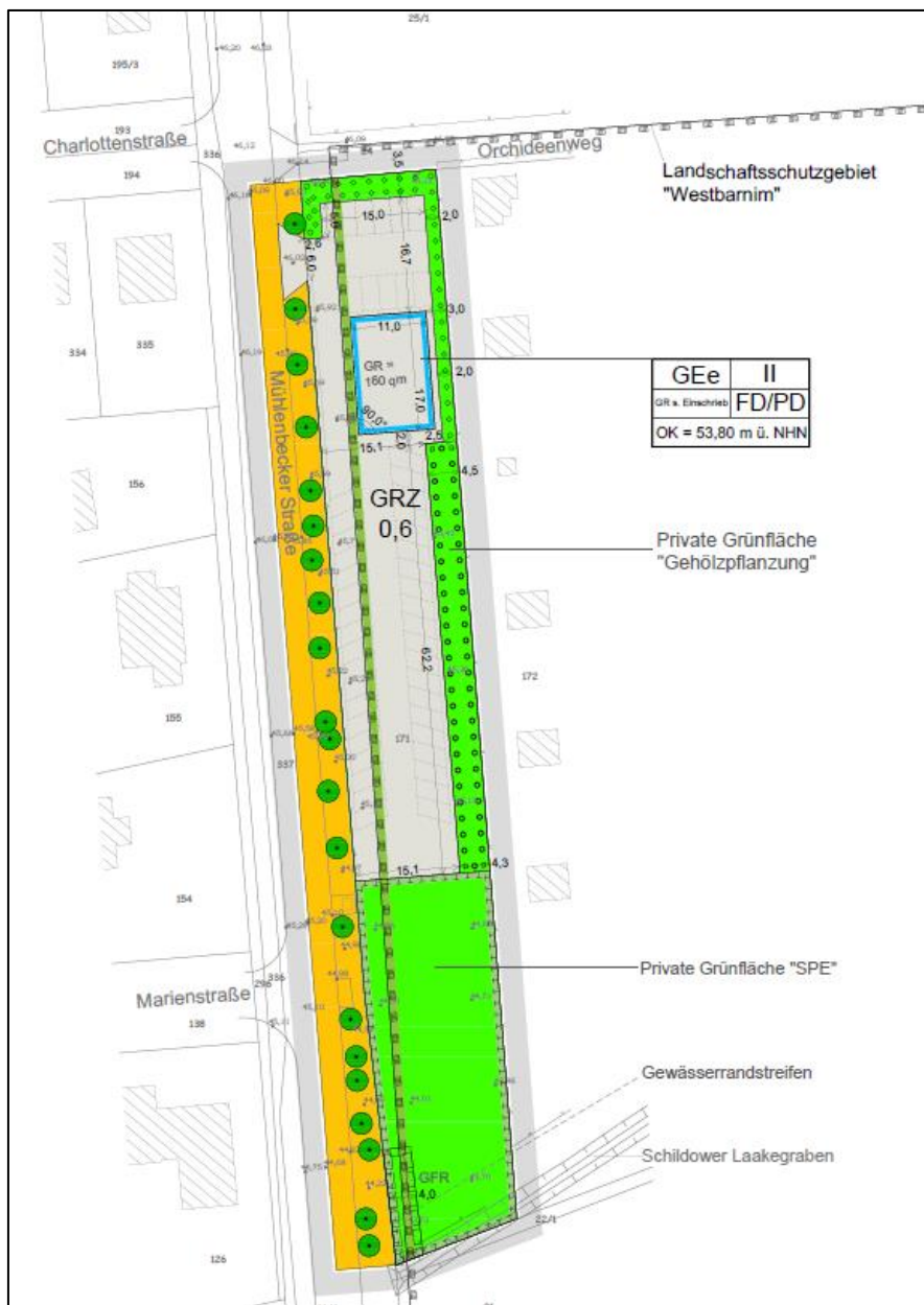
Abb. 1: Vorhabenbezogener Bebauungsplan GML Nr. 33 „Bürogebäude und Autohandel Mühlenbecker Straße“ Gemeinde Mühlenbecker Land, OT Schildow - Entwurf Stand Januar 2022
