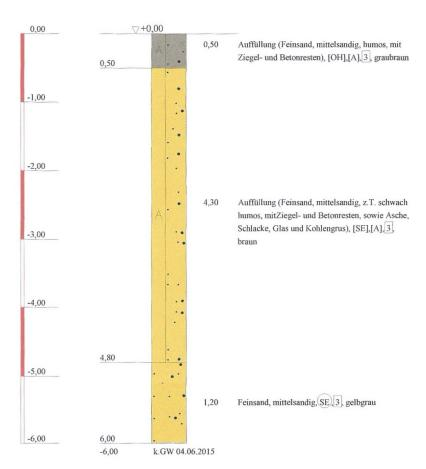
Baugrunduntersuchung / Altlastenerkundung
