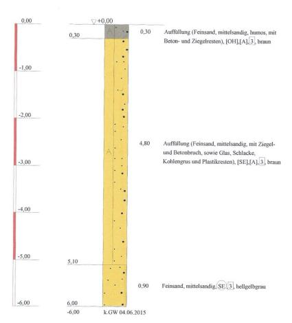
Baugrunduntersuchung / Altlastenerkundung
