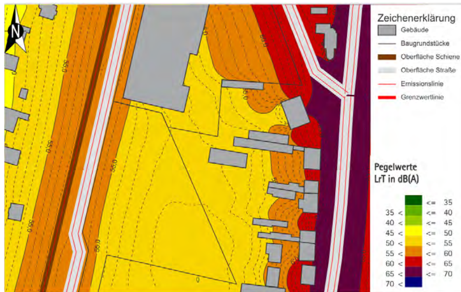
Abbildung 5-9 Isophonenkarte in 8 m Höhe über Gelände | Beurteilung nach DIN 18005 | 06:00 - 22:00 Uhr
