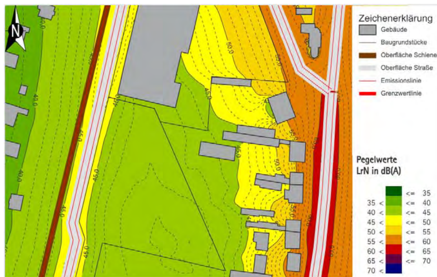
Abbildung 5-10 Isophonenkarte in 8 m Höhe über Gelände | Beurteilung nach DIN 18005 | 22:00 - 06:00 Uhr
