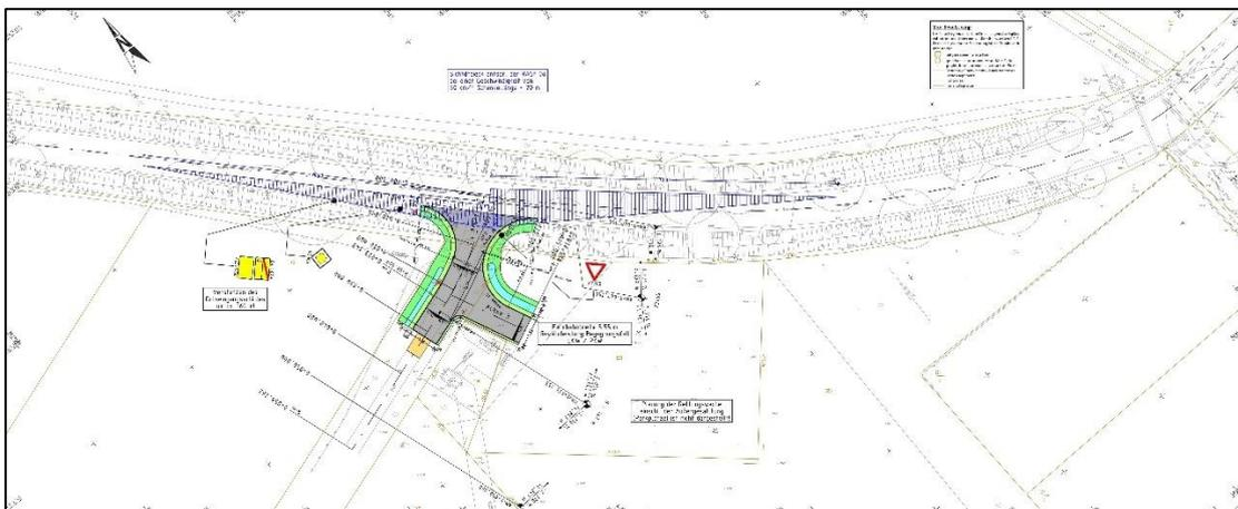
**Abb. 8:** Sichtdreieck bei einer Geschwindigkeit von 50 km/h (Voruntersuchung Dr. Löber Mai 2022)
